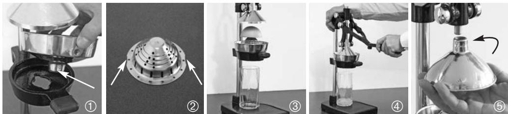
Mettere l'imbuto nel supporto dello spremiagrumi. Facendo attenzione di inserirlo nei corrispondenti alloggi ricavati (immagine 1). Per fissare l'imbuto girarlo un po' a destra o sinistra. Fissare in seguito la pigna nell'imbuto, facendo attenzione di inserirla anche nei corrispondenti alloggi ricavati (immagine 2).
