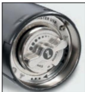
Das Mahlwerk lässt sich an der Unterseite mit Hilfe einer Einrastfunktion in feinen Stufen einstellen. Die Zahlen 0 - 11 auf der Mitnehmerplatte dienen zur besseren Orientierung und sorgen für eine einfache Ablesbarkeit des Mahlgrades. Eine ganze Umdrehung entspricht 12 Klicks. Ermitteln Sie den gewünschten Mahlgrad, in dem Sie die Mühle probemahlen:
