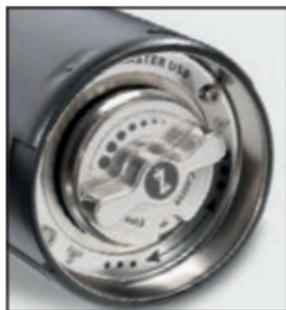
Le mécanisme de broyage peut être réglé sur des niveaux précis par le dessous à l'aide d'une fonction de cliquet. Les chiffres de 0 à 11 sur la plaque d'entraînement servent à mieux s'orienter et assurent une lisibilité facile du degré de mouture. Un tour complet correspond à 12 clics. Déterminez le degré de mouture souhaité par moudre à l'essai :
