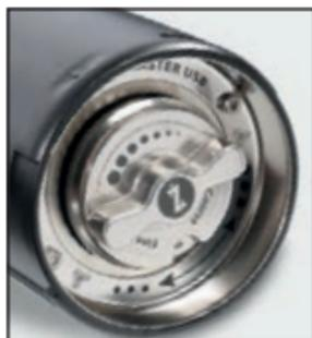
Il meccanismo può essere regolato dal lato inferiore a intervalli di precisione con l'ausilio della funzione a scatti. I numeri da 0 a 11 sulla piastra di guida servono per orientarsi meglio e garantire una facile leggibilità della macinatura. Un giro completo corrisponde a 12 scatti. Si raccomanda di identificare il grado di macinatura desiderato mediante macinature di prova del macinacaffè:
