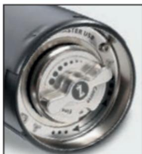
Het maalwerk kan aan de onderkant met behulp van een klik functie in fijne trappen worden ingesteld. De nummers 0 - 11 op de plaat van de bestuurder dienen voor een betere oriëntatie en zorgen voor een goede afleesbaarheid van de maalgraad. Een volle draai komt overeen met 12 klikken. Bepaal de gewenste maalgraad met een aantal proefmalingen van de molen:
