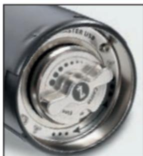
El mecanismo de molienda se puede ajustar a distintos niveles por la parte inferior con ayuda de una función de enclavamiento. Los números 0 - 11 de la placa del conductor sirven para orientarse mejor y garantizar una fácil legibilidad de la molienda. Una vuelta completa corresponde a 12 clics. Haga pruebas para calcular el grado de molienda deseado:
